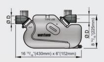
LSS40A LSS45A LSS50A Capacity 71/2 litres (2 gal.)
