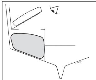
Le réservoir doit toujours être placé au-dessus du niveau maximum de l'eau de cale.
