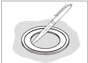
Schneiden Sie mit einer Schere das Loch in die Tankwand.
