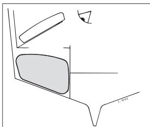
De tank dient steeds boven het maximale niveau van het bilgewater te worden opgesteld.
