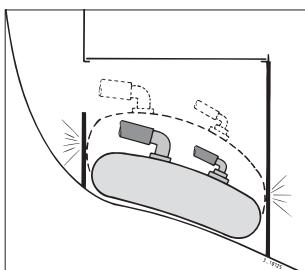
Der Boden und die Wände müssen glatt sein. Andernfalls kleiden Sie den Boden und die Wände mit Schaumstoff oder Filz aus.
