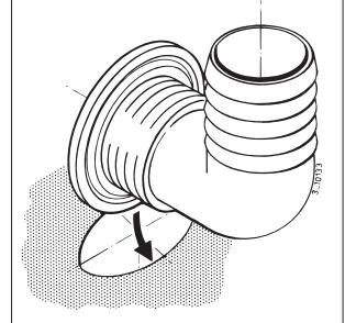
Placer la rondelle et l'écrou. Serrer l'écrou avec la clé, ne jamais utiliser une pince multiprise.
