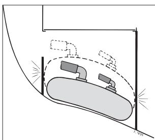
El fondo y las paredes han de estar lisos; en caso contrario, revestir el fondo y las paredes con espuma o filtro.
