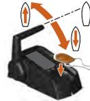
Fig. 81: Accelerator lever
