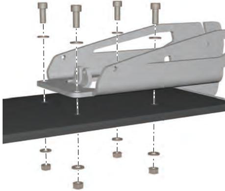
Abb. 9: Montage Adapterplatte
