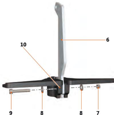
Abb. 12: Steuerdreieck und Schwenkarm
