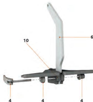
Abb. 13: Steuerdreieck und Schwenkarm
