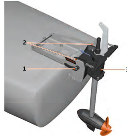
Abb. 20: Eingesetzte Schwinge
