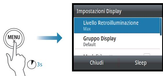
Quando il campo Livello Retroilluminazione è attivo, premendo ancora il tasto **MENU** è possibile regolare il livello della retroilluminazione con decrementi del 30%.
