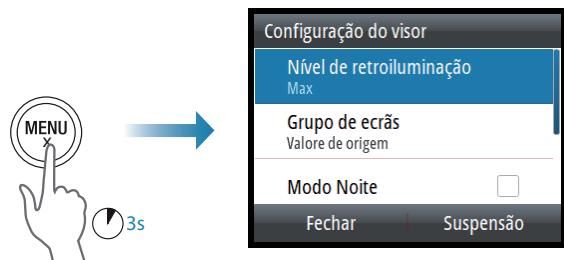
Quando o campo do nível de retroiluminação estiver ativo, as pressões subsequentes na tecla de **MENU** ajustam o nível da retroiluminação em passos de 30%.
