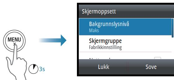
Når feltet for nivå på bakgrunnsbelysning er aktivt, fører de neste trykkene på **MENU**-tasten til at nivået på bakgrunnsbelysningen justeres ned i trinn på 30 %.
