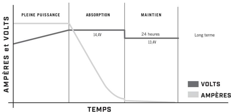
**AVIS :** En rangement, le chargeur reprendra automatiquement le processus de charge avec le mode Pleine puissance lorsque la tension de la batterie tombe sous 12,6 V.
