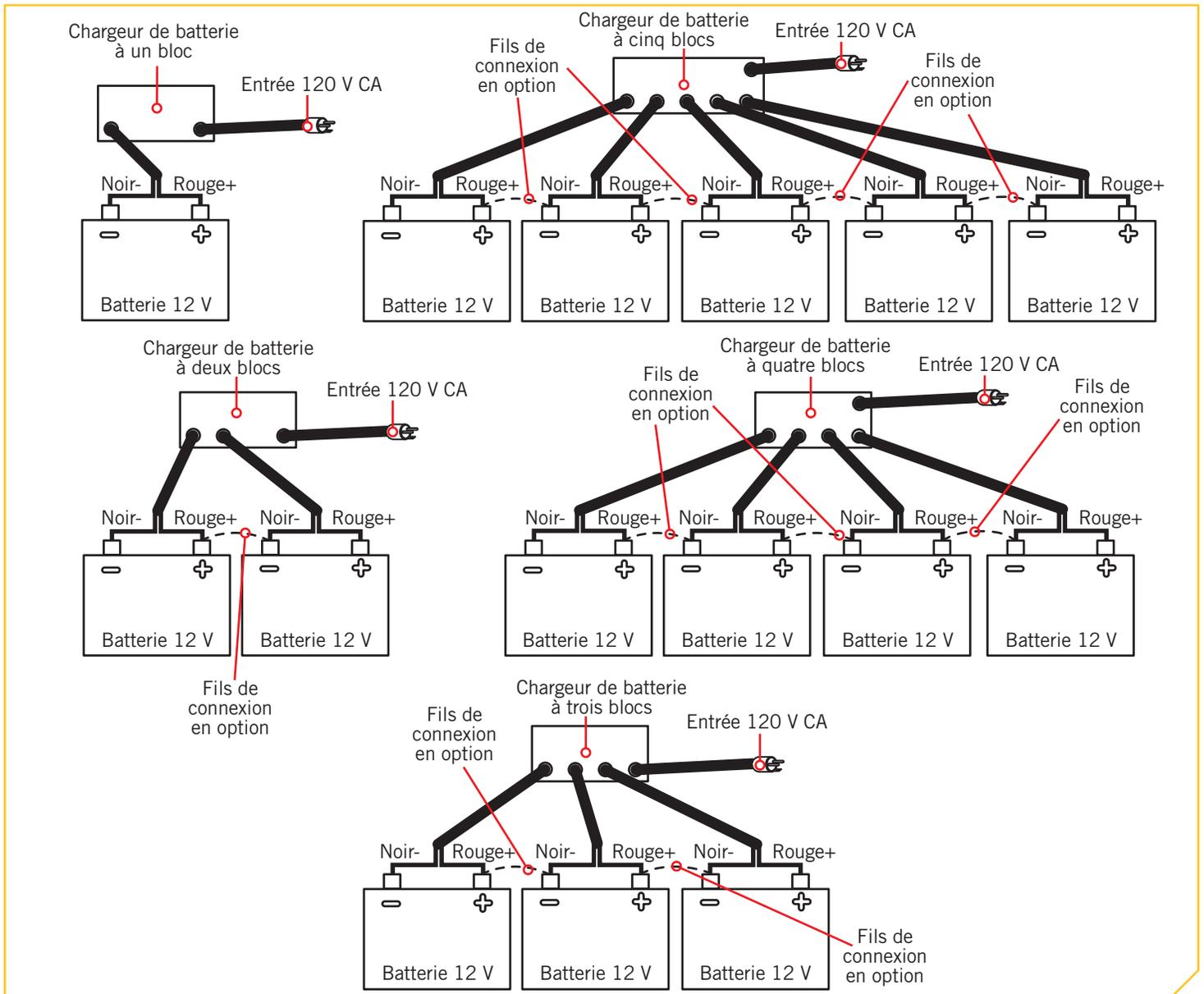
**AVIS :** Si les batteries sont connectées en série avec des fils de connexion, ces fils peuvent rester en place lors du chargement.
