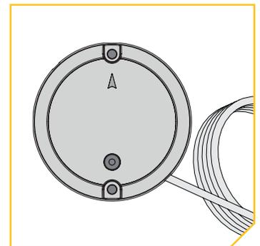
**AVIS :** S'il faut utiliser des vis de remplacement, assurez-vous qu'elles sont fabriquées en acier inoxydable non magnétique de haute qualité.
