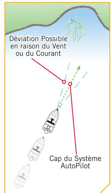
**AVIS :** Après avoir établi une nouvelle orientation, il y a un court délai avant que l'orientation ne soit verrouillée, afin de permettre à la boussole de se stabiliser. Lors de grands changements de vitesse, le cap du système AutoPilot pourrait changer légèrement. C'est normal.
