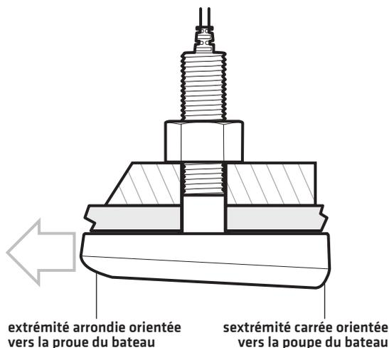
2. Insérez le transducteur dans le trou percé depuis l'extérieur du bateau, avec la ou les cales installées conformément à votre type d'installation.
