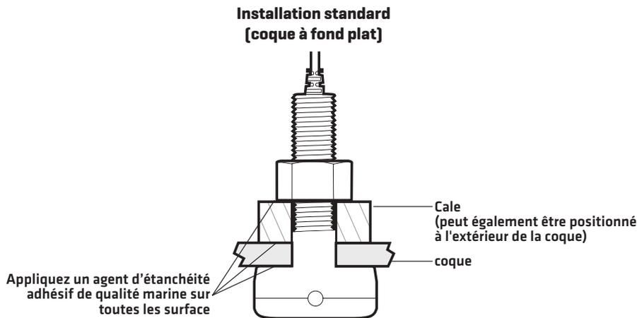
1. Depuis l'extérieur de la coque, percez un petit trou de guidage [plus petit que la pointe de centrage de votre perceuse ou scie-cloche] à l'emplacement de montage sélectionné à la section 2. **Percez le trou perpendiculairement à la coque.**
