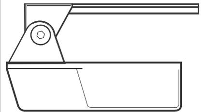
Le support de montage doit être parallèle au transducteur.
