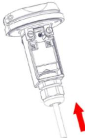
**1.9** Die Kabelverschraubung so verschrauben, dass die Dichtung dicht ist
