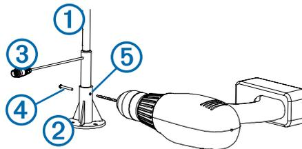
**REMARQUE :** si vous n'installez pas la girouette pointée vers la proue du bateau et parallèlement à la ligne médiane, ou si vous installez l'appareil en orientant le câble vers la poupe du bateau, vous devez configurer l'orientation de la girouette pour recevoir des données corrigées sur l'angle du vent ([Réglage de l'orientation, page 6](#)).
