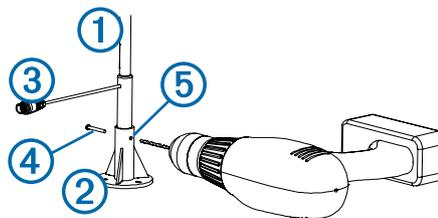
**MERK:** Hvis du ikke monterer enheten slik at kabelen vender mot baugen på båten, nøyaktig parallelt med senterlinjen, eller hvis du monterer enheten slik at kabelen vender mot akterenden på båten, må du konfigurere retningen for å få nøyaktige vindvinkeldata ([Justere retningen, side 30](#)).
