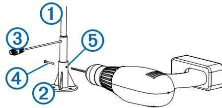
**OPMERKING:** Als u het toestel niet monteert met de kabel gericht naar de voorzijde van de boot, exact parallel aan de middenlijn, of als u het toestel monteert met de kabel gericht naar de achterzijde van de boot, moet u de oriëntatie configureren om nauwkeurige windhoekgegevens te ontvangen ([De richting aanpassen, pagina 21](#)).
