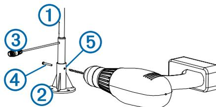
**Obs!** Om du inte monterar enheten med kabeln vänd mot båtens för, exakt parallellt med centerlinjen, eller om du monterar enheten med kabeln vänd mot båtens akter måste du konfigurera orienteringen så att du får exakta vindvinkeldata ([Justera riktningen, sidan 33](#)).
