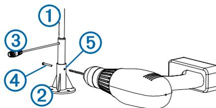
**NOTA:** caso não instale o dispositivo com o cabo voltado para a frente da embarcação, exatamente em paralelo à linha central ou caso instale o dispositivo com o cabo voltado para a parte de trás da embarcação, terá de configurar a orientação, de modo a receber dados precisos do ângulo do vento ([Ajustar a orientação, página 18](#)).
