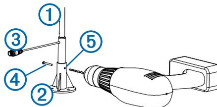
**POZNÁMKA:** Jestliže zařízení nenainstalujete tak, aby kabel směřoval k přední části lodi zcela souběžně s osou lodi, nebo pokud zařízení nainstalujete tak, že kabel směřuje k zadní části lodi, musíte provést konfiguraci orientace, aby zařízení získalo přesné údaje o úhlu větru ([Úprava orientace, strana 39](#)).
