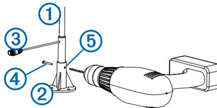
**UWAGA:** Jeśli przewód zamontowanego urządzenia nie będzie zwrócony dokładnie w stronę przodu łodzi (równoległe do linii środkowej łodzi) lub będzie zwrócony w stronę rufy, należy skonfigurować orientację urządzenia, aby otrzymać precyzyjne dane kąta wiatru ([Regulowanie orientacji, strona 36](#)).
