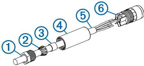
5 使用接头 ⑥ 背面的螺丝，将每根电线连接至相应接线端。
